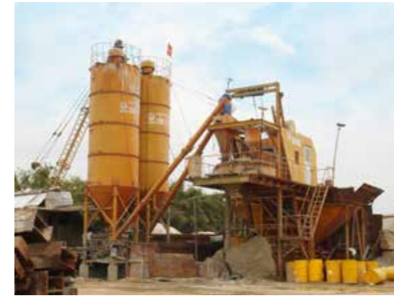
Trạm trộn bê tông IBM BM60
